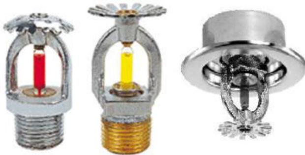
*L'erogazione di acqua può essere comandata da un impianto di rilevazione incendi, oppure essere provocata direttamente dalla apertura delle teste erogatrici: per fusione di un elemento metallico o per rottura, a determinate temperature, di un elemento termosensibile a bulbo che consente in tal modo la fuoriuscita d'acqua.*
